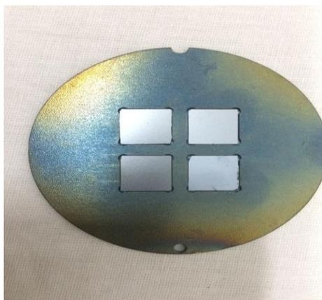
Рисунок 3.8 – держатель образцов установки импульсного лазерного осаждения с установленными образцами.
