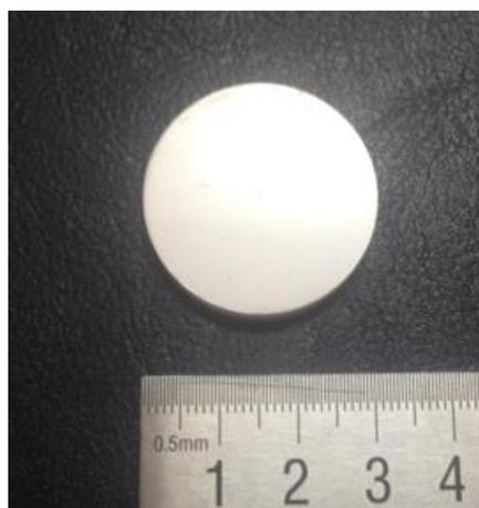
Рисунок 3.4 – Цель PZT полученная горячим прессованием порошков  $\text{PbO}$ ,  $\text{TiO}_2$  и  $\text{ZrO}_2$
