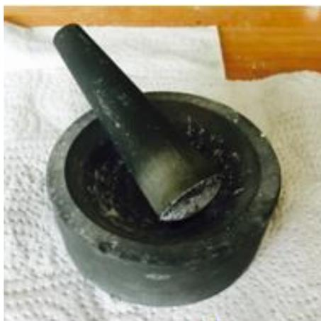
Рисунок 3.1 – Агатовая ступка для смешивания и предварительного перемола порошков
