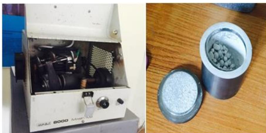
Рисунок 3.2 – Шаровидная мельница «SPEX8000» с цилиндром и шариками с карбида вольфрама.
