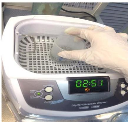
Рисунок 3.7 – процесс очистки образца от загрязнения в ультразвуковой ванне.
