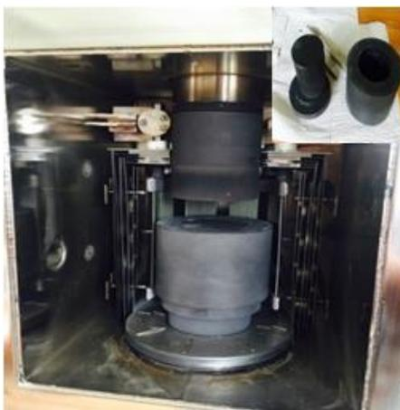
Рисунок 3.3 – Камера для горячего прессования и графитовая прессформа
