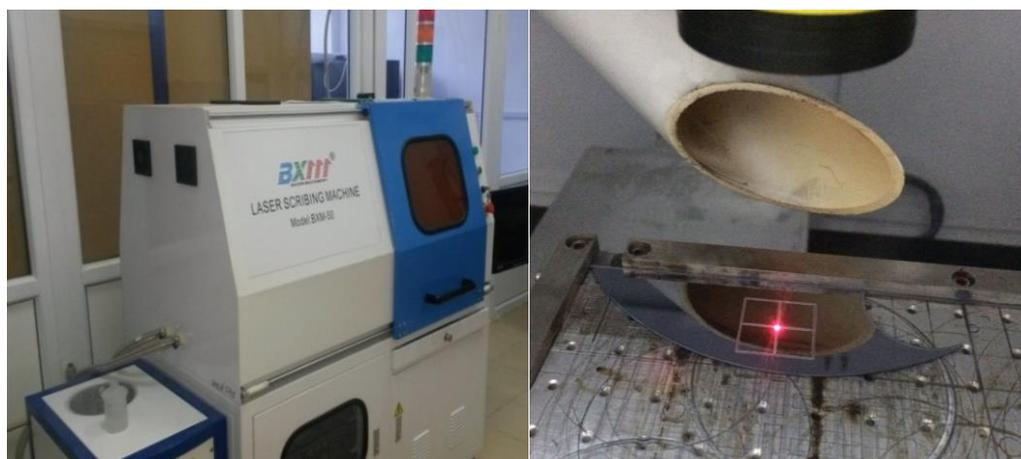
Рисунок 3.6 – Установка лазерной нарезки компании BX 111 Laser Scribing machine (Model: BXM-50).
